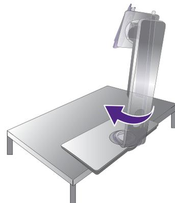
鎖緊顯示器底座下面的大頭螺絲，如圖所示。然後依逆時針方向轉動支架，讓支架面向前。
