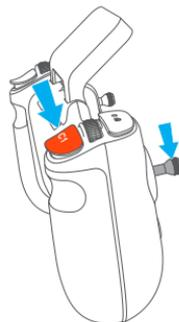
Después de activarlo, presione el botón C1 y simultáneamente mueva hacia abajo de la palanca de control izquierda durante 2 segundos para desbloquear los motores. Suelte primero la palanca de control para despegar; de lo contrario, las hélices dejen de girar si suelta primero el botón C1.
