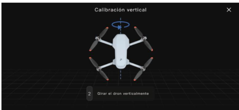
⚠ • Cuando recibas el mensaje "Calibración fallida" en la aplicación Potensic Eve de forma repetida, cambia de ubicación y vuelve a intentar el procedimiento de calibración.
