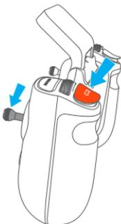
Después de activarlo, presione el botón C2 y simultáneamente mueva hacia abajo de la palanca de control derecha durante 2 segundos para desbloquear los motores. Suelte primero la palanca de control para despegar; de lo contrario, las hélices dejen de girar si suelta primero el botón C2.
