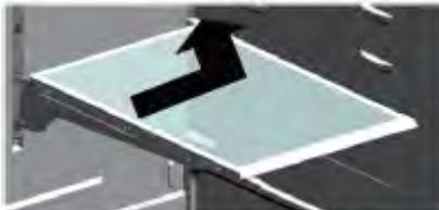
2. Pour réinstaller une étagère, faites-la glisser doucement dans le compartiment réfrigérateur, puis abaissez-la sur les guides d'étagère de sorte que les crochets s'insèrent derrière les guides arrière.
