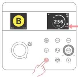
③ Drücken Sie den Einstelllichtschalter „**PROP**“, bis das Einstelllicht und das Symbol „**AUS**“ in der unteren rechten Ecke des Hauptbildschirms erscheinen, was anzeigt, dass das Einstelllicht ausgeschaltet ist.
