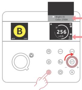
② Drücken Sie den „**PROP**“ Schalter für das Einstelllicht. Das Symbol für das Einstelllicht und der entsprechende Wert werden in der unteren rechten Ecke des Hauptbildschirms angezeigt. Halten Sie dann den Schalter für das Einstelllicht 2 Sekunden lang gedrückt, um die Oberfläche für die Parametereinstellung aufzurufen. Drehen Sie das Einstellrad, um die Helligkeitsstufe (01-10) und den Farbtemperaturwert (2700K-6500K) auszuwählen.
