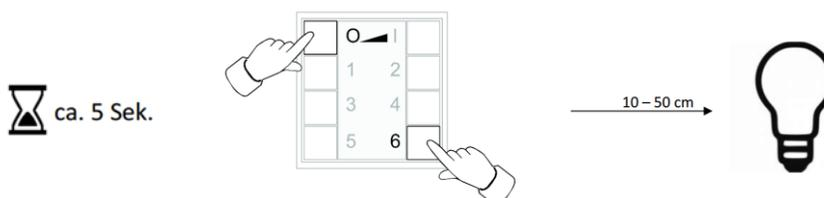
Begeben Sie sich in unmittelbarer Nähe zur gewünschte Leuchte und betätigen Sie anschließend die angezeigten Tasten für ca. 5 Sekunden bis die LED's am Sender blinken.
