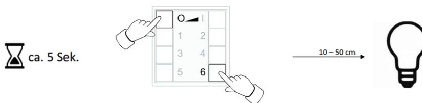
Begeben Sie sich in unmittelbarer Nähe zur gewünschte Leuchte und betätigen Sie anschließend die angezeigten Tasten für ca. 5 Sekunden bis die LED's am Sender blinken.
