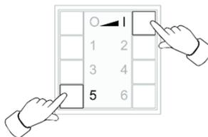
Betätigen Sie anschließend die angezeigten Tasten für ca. 5 Sekunden bis die LED's am Sender blinken.
