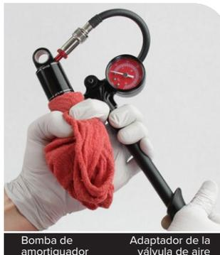
Bomba de amortiguador      Adaptador de la válvula de aire
