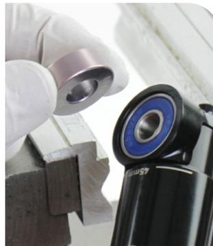
**3** Introduzca un nuevo espaciador en el ojal y, a continuación, instale un rodamiento nuevo en el otro orificio del rodamiento.
