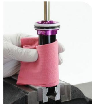
Sustituya la junta tórica o de estanqueidad por otra nueva del kit de mantenimiento. Utilice los dedos o un punzón para perforar y retirar la junta tórica o de estanqueidad antiguas.
