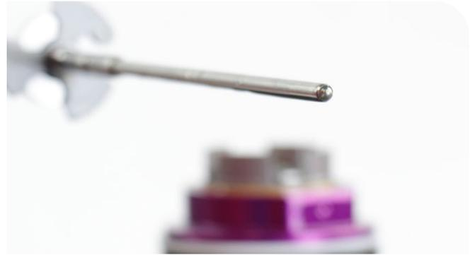
**Select+ RT, Select+ RL:** Tire del conjunto de aguja de compresión y pistón de bloqueo para sacarlos del pistón del amortiguador y el eje del amortiguador. Deje el conjunto de aguja de compresión a un lado.
