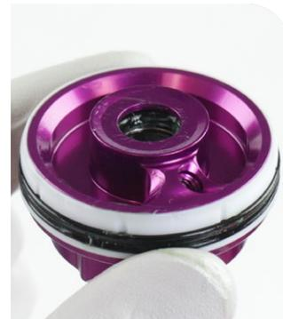
**13** Retire la junta tórica interior de la parte inferior del cabezal de sellado/pistón neumático y deséchela.
