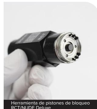
**29** Enrosque a mano el pistón de bloqueo en el pistón. Aplique una presión uniforme hacia abajo sobre la herramienta de pistones de bloqueo RCT/NUDE Deluxe al instalar el pistón de bloqueo para evitar que la herramienta se deslice sobre el pistón y dañe el pasador de guía.
