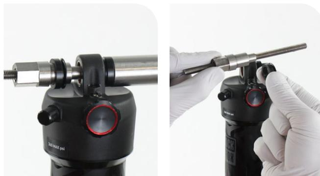
**4** Si el pasador del casquillo no sale fácilmente, vuelva a introducir la varilla roscada y el pasador de empuje a través del ojal del eje.
