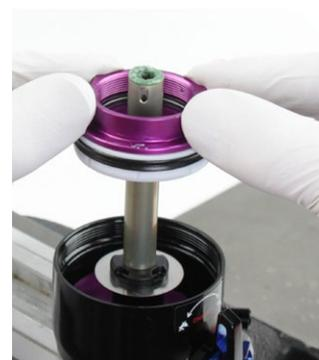
**19** Coloque el cabezal de sellado/pistón neumático justo debajo del extremo del eje del amortiguador.
