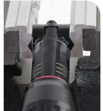
**2** Afloje el tornillo de banco, alinee la herramienta de prensa de rodamientos con el centro del rodamiento y apriete lentamente el tornillo de banco. Compruebe y confirme que la herramienta de prensa de rodamientos está centrada y no montada sobre el borde del rodamiento.
