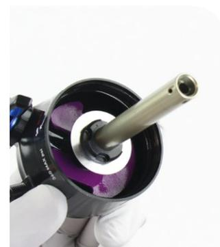
**12** Retire la junta tórica interior del cabezal de sellado/pistón neumático y deséchela.
