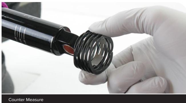
Los elementos Bottomless Token reducen el volumen de aire de la lata de aire del amortiguador trasero y crean una mayor progresión, o rampa del resorte, al final de su recorrido. Agregue o retire elementos Bottomless Token para ajustar la rampa del resorte.
