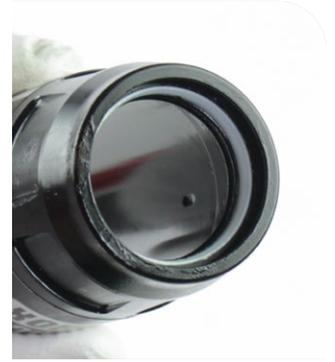
**6** Instale una junta antipolvo nueva en la lata de aire.
