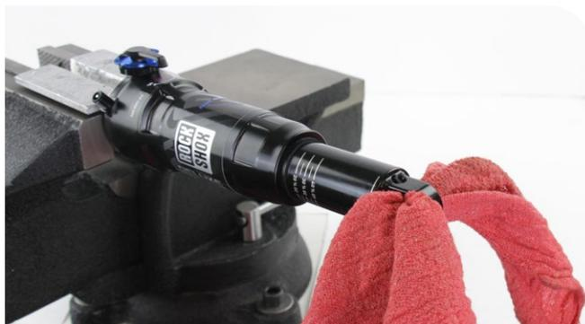
**Ojal de rodamiento:** Si lo ha retirado previamente, instale temporalmente el conjunto del ojal de rodamiento en el cuerpo del amortiguador. Envuelva una toalla de tela alrededor del conjunto del ojal de rodamiento para protegerlo.
