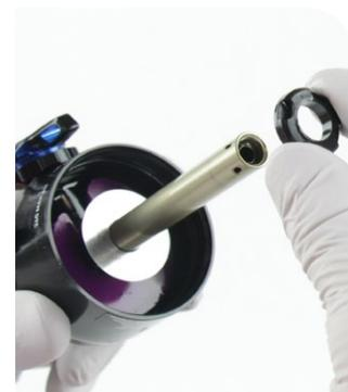
**11** Limpie el eje del amortiguador.
