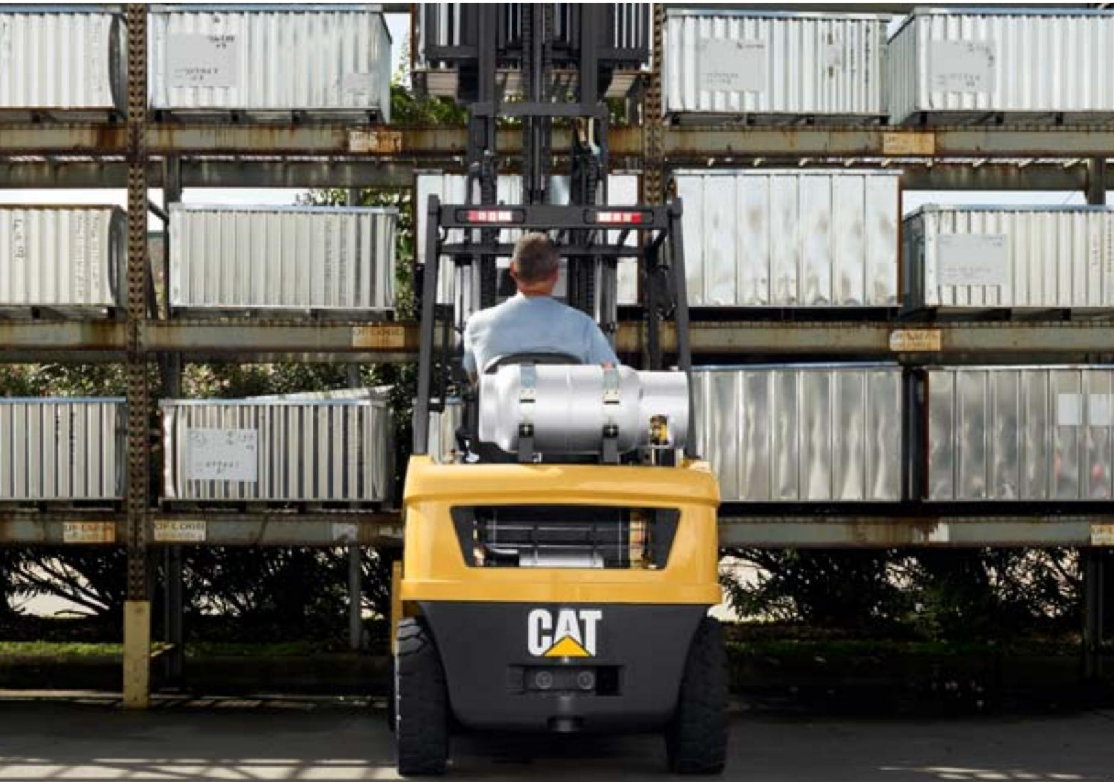
El contrapeso con diseño de bajo perfil, le da buena visibilidad hacia atrás, aun con el tanque de gas LP instalado. Se ha eliminado la barra cruzada de la guarda del operador con el nuevo diseño que optimiza la resistencia y mejora la visibilidad.
