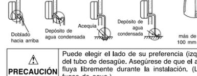
Puede elegir el lado de su preferencia (izquierdo o derecho) para la instalación del tubo de desagüe. Asegúrese de que el agua condensada de la unidad interior fluya libremente durante la instalación. (La falta de cuidado puede provocar fugas de agua.)
