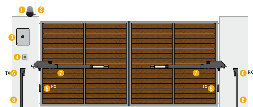
1_Lampeggiatore 2_Antenna da esterno 3_Centrale di comando 4_Selettore a chiave 5_Fotocellule CHIUSURA 6_Fotocellule APERTURA 7_Attuatori 8_Colonnina fotocellule
