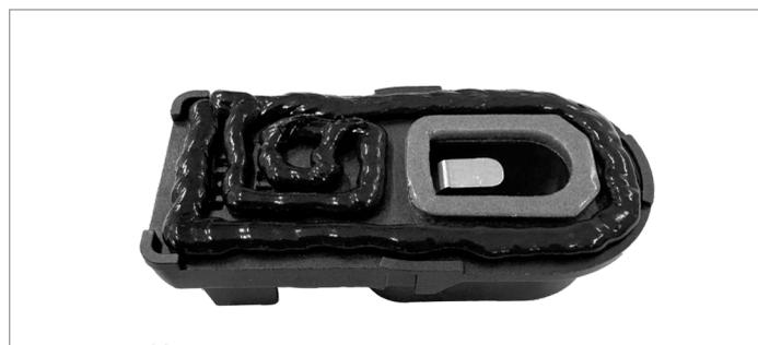
4. Anschlussdosen umgehend senkrecht auf der vorbereiteten Fläche auf dem PV-Modul anbringen, bevor sich am Kleb- und Dichtstoff eine Haut bildet.
