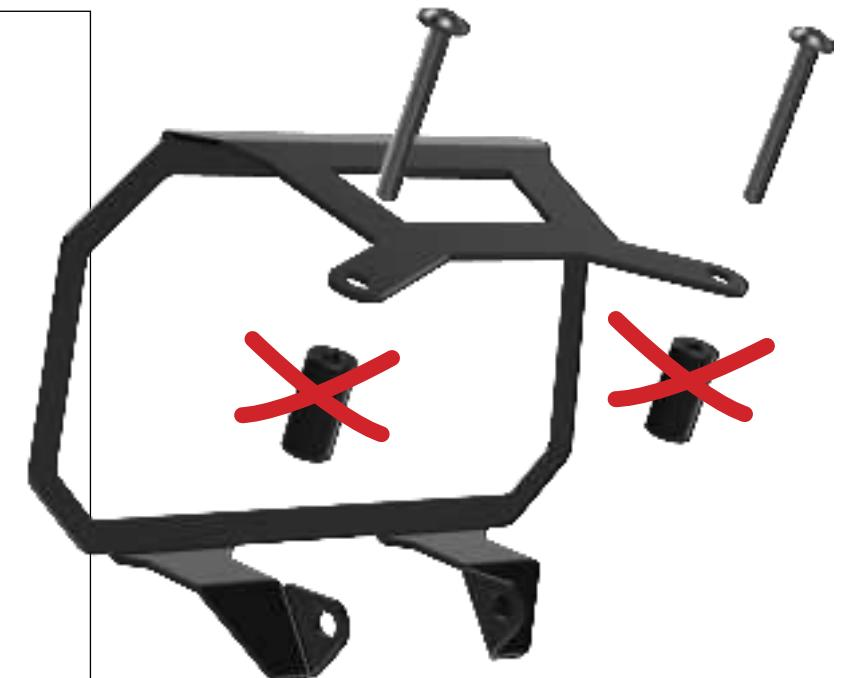
**HÜLSEN ENTFALLEN BEI DER MONTAGE MIT NAVI-HALTER.**
