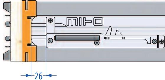
2. Se la misura rilevata è uguale a 133mm, posiziona la base del rallentatore a 26mm dal montante di battuta.
