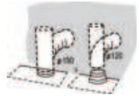
Wenn Sie einen 120-mm-Abluftanschluss installieren möchten, setzen Sie den Reduzierflansch **3** auf den Abluftstutzen der Haube. Befestigen Sie das Rohr **4** mit ausreichend Rohrschellen (nicht im Lieferumfang enthalten).
