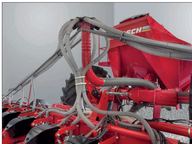
Elosztótorny a műtrágyát vezető tömlővel
