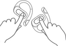
双耳从充电仓取出后会自动开机配对, 耳机未与蓝牙设备连接或耳机从蓝牙设备取消连接状态下, 分别对左耳机和右耳机连续五次多功能键, 提示音“嘟”四声后, 耳机自动关机后将双耳机放回充电仓, 再将双耳机取出, 双耳机会自动配对, 完成后即可连接蓝牙设备使用。
