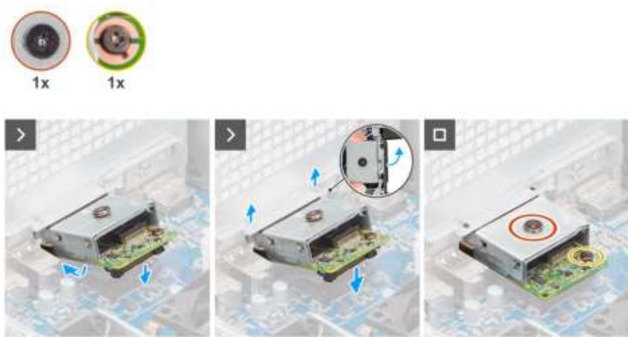
Figure 78. Installing the optional LAN module
