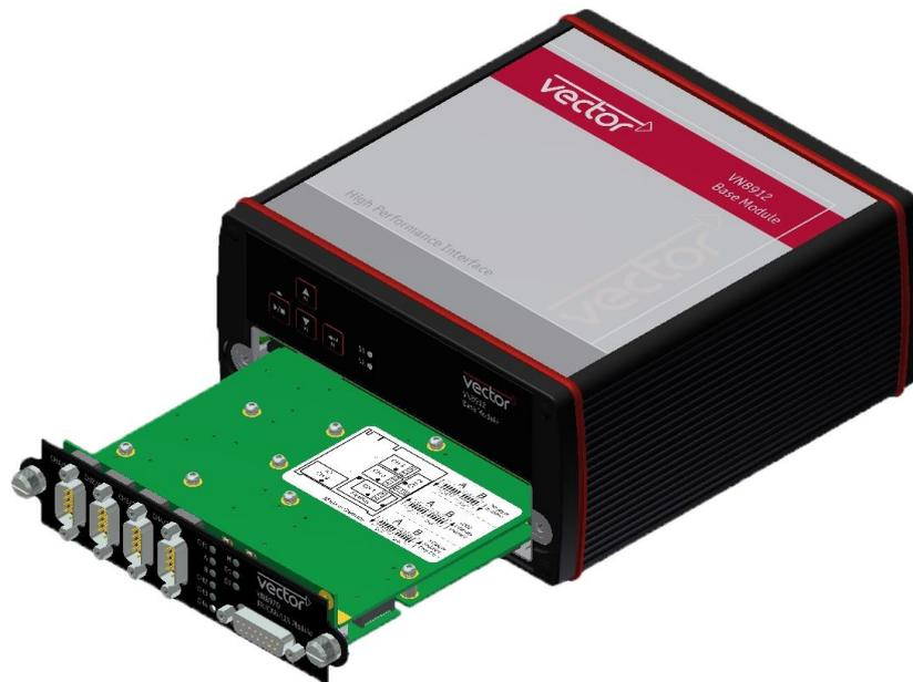
図 17: VN8912の前面 (VN8970プラグインモジュールを挿入している状態)
