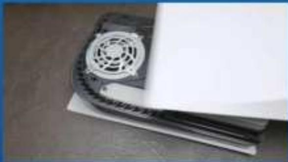
**11. REINSTALE LA PLACA DE APOYO DESLIZÁNDOLA HACIA ATRÁS Y EMPUJÁNDOLA HACIA ABAJO.**
