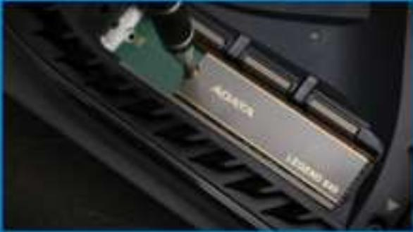
**9. FASTEN THE SSD WITH THE SCREW.**
