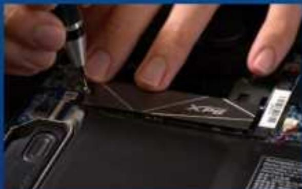
プラスドライバーでM.2 SSDを固定します。
