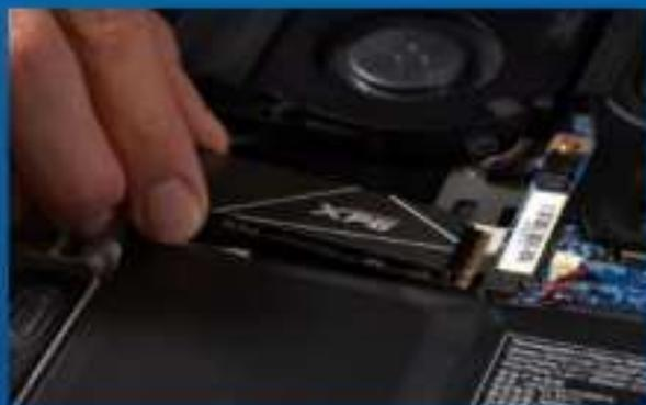
軸径の小さなプラスドライバーでマザーボード上のねじを取り外します。SSDのピンをスロットの溝に合わせ、SSDのピンの切り欠きがPCIeスロットの形状に合っている（正しい方向になっている）ことを確認し、斜めに差し込みます。最後まで押し込んで確実に固定されていることを確認します。
