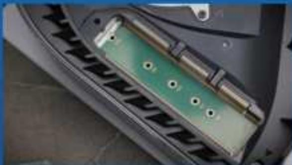
**7. COLOQUE EL ESPACIADOR EN EL ORIFICIO CORRESPONDIENTE AL FACTOR DE FORMA M.2.**
