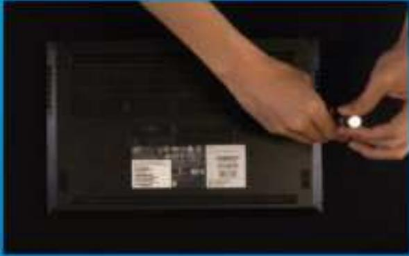
正しい直径のプラスドライバーを使用してバックパネルのねじを取り外します。
