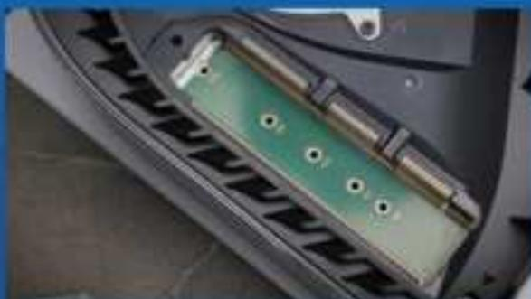
**7. COLOQUE O ESPAÇADOR NO ORIFÍCIO QUE CORRESPONDE AO FATOR DE FORMA M.2.**
