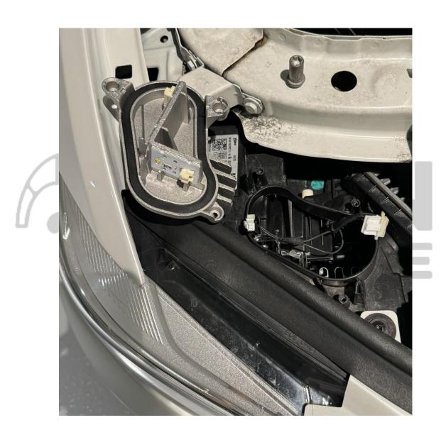
PLUG THE (2) CABLES BACK INTO THE NEW HEATSINK.
