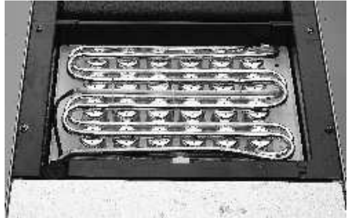
Pour Scale Remover Over The Evaporator Section
