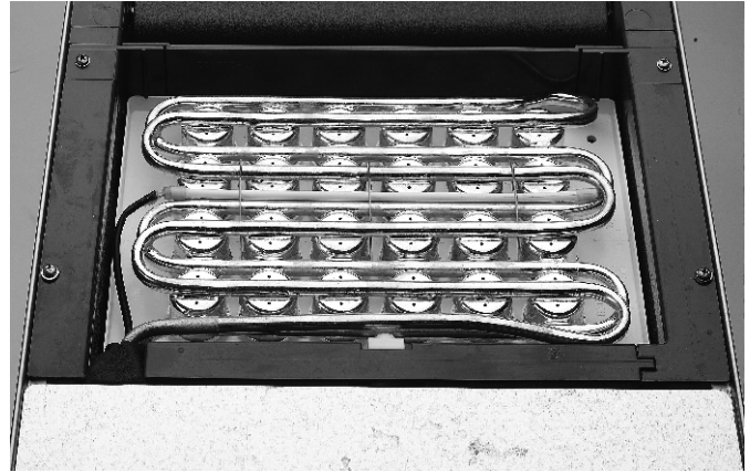
Pour Scale Remover Over The Evaporator Section
