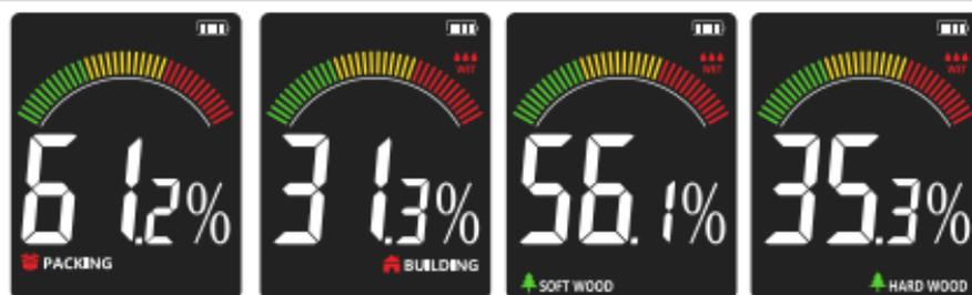
Die Messdaten erreichen den Maximalwert und blinken, diese Anzeigeschnittstellen zeigen an, dass die Messdaten über der Obergrenze liegen (evtl. weil das Material leitfähig ist oder das Material zu nass ist etc.).
