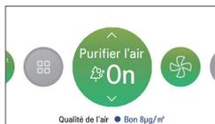
Dans le cas du fonctionnement simple de la purifier l'air, le climatiseur fonctionne en mode ventilation au réglage automatique et dans le sens de ventilation réglé jusqu'à ce que la fonction soit arrêtée.
