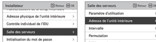
2. Réglez le « Paramètre d'utilisation », le « Unité intérieure Total », l'« Adresse de l'unité intérieure », les paramètres de temps et de température pour le fonctionnement alternatif/dé secours.
