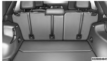
Emplacements des ancrages d'attache
