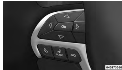
Boutons de commande de l'écran d'information du conducteur (DID)
