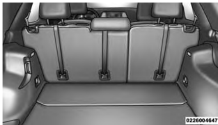
Emplacements des ancrages d'attache
