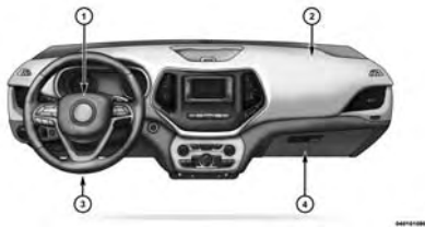
Emplacement des sacs gonflables avant évolués et des protège-genoux
