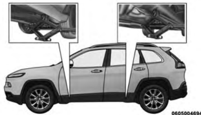
Emplacements de levage
