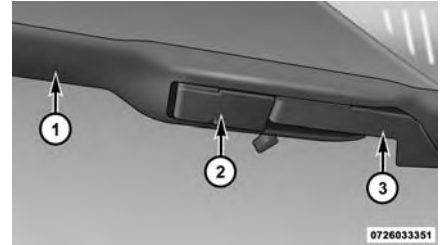
Balai d'essuie-glace avec patte de déverrouillage en position verrouillée
