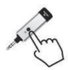
ボタンを1回押してデバイスの電源をオンにすると、 LEDインジケーターが青と赤で点滅します (ペアリングの準備ができています)
