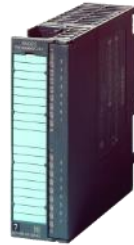
1 x Digital module SM 323, 16 DI and 16 DQ, 24 V DC, 0.5 A, 40-pin
