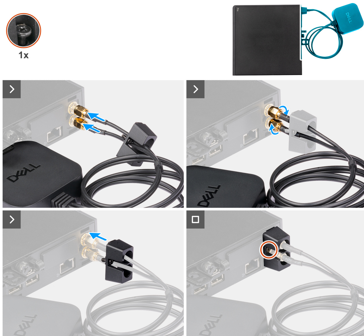
Figura 35. Como instalar a antenna puck externa
