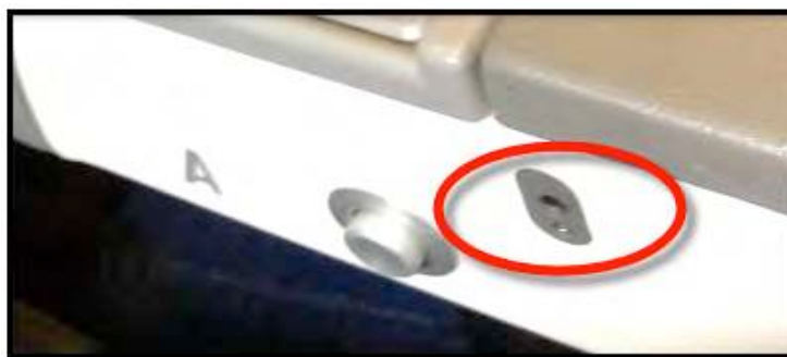
飛機座椅（扶手）上的輸入插孔
