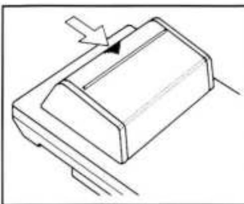
Verbind de polen van de meegeleverde blokbatterij (type 6 F 22, 9 Volt) met de drukknoopcontacten in het batterijvak.
