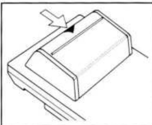
Raccordez les deux pôles de la pile (type 6 F 22, 9 volts) aux contacts-boutons du compartiment-pile.
