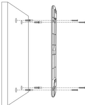
b. Lors de la fixation de la barre de support sur des murs en plâtre ou en bois, vous pouvez utiliser des vis directement pour serrer la barre de support.
