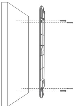
6. Décollez le film d'arrière adhésif et fixez les deux l'applique murale à la barre de support. Alignez la fente à l'arrière de l'applique murale avec la position de la boucle de la barre de support et faites-la glisser vers le bas pour la fixer.
