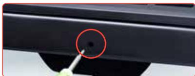
Saisissez la partie supérieure de la poignée. Insérez un tournevis dans le trou situé à l'intérieur du panier (au-dessus de la fenêtre). Poussez le tournevis vers l'intérieur et tirez la poignée vers le haut en même temps.
