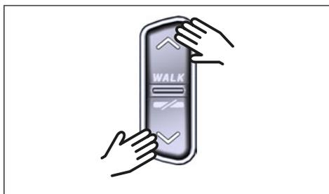
Fig. 6: Selección del nivel de soporte en el HPR Remote V02
