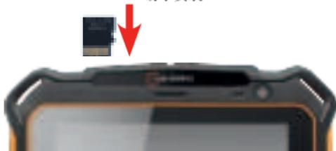
» 打开SD卡插槽上的IP PLUG。
