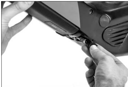
Fig. 30: Blocage de la batterie de transmission
