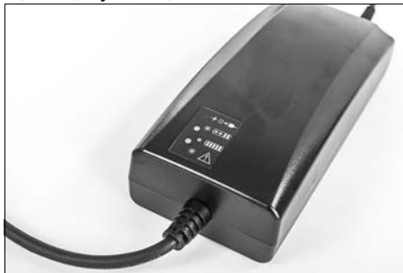
Fig. 22: Aperçu des voyants de contrôle
