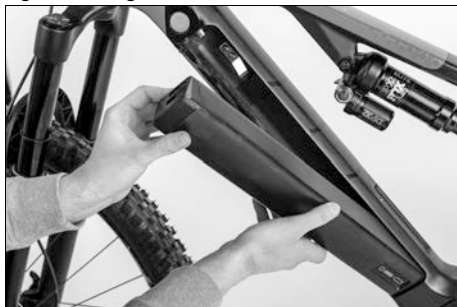
Fig. 28: Montage de la batterie de transmission
