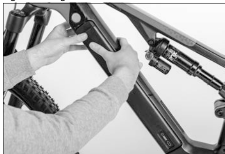
Fig. 29: Blocage de la batterie de transmission
