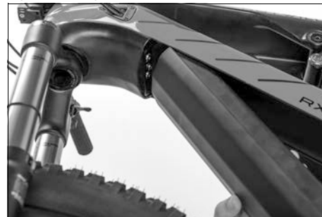
Fig. 33: Montage de la batterie de transmission
