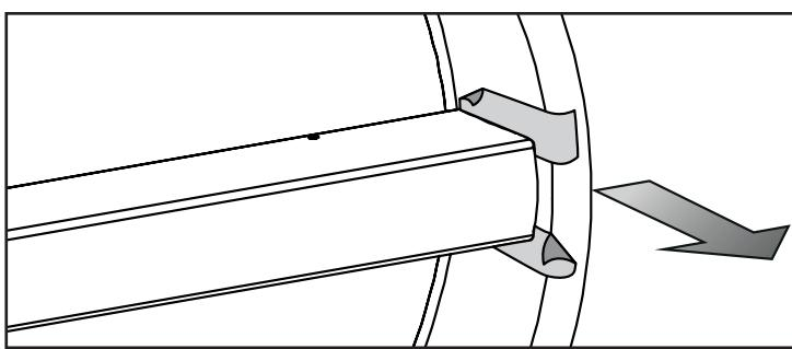
Schutzfolie nach abgeschlossenem Einbau entfernen.
