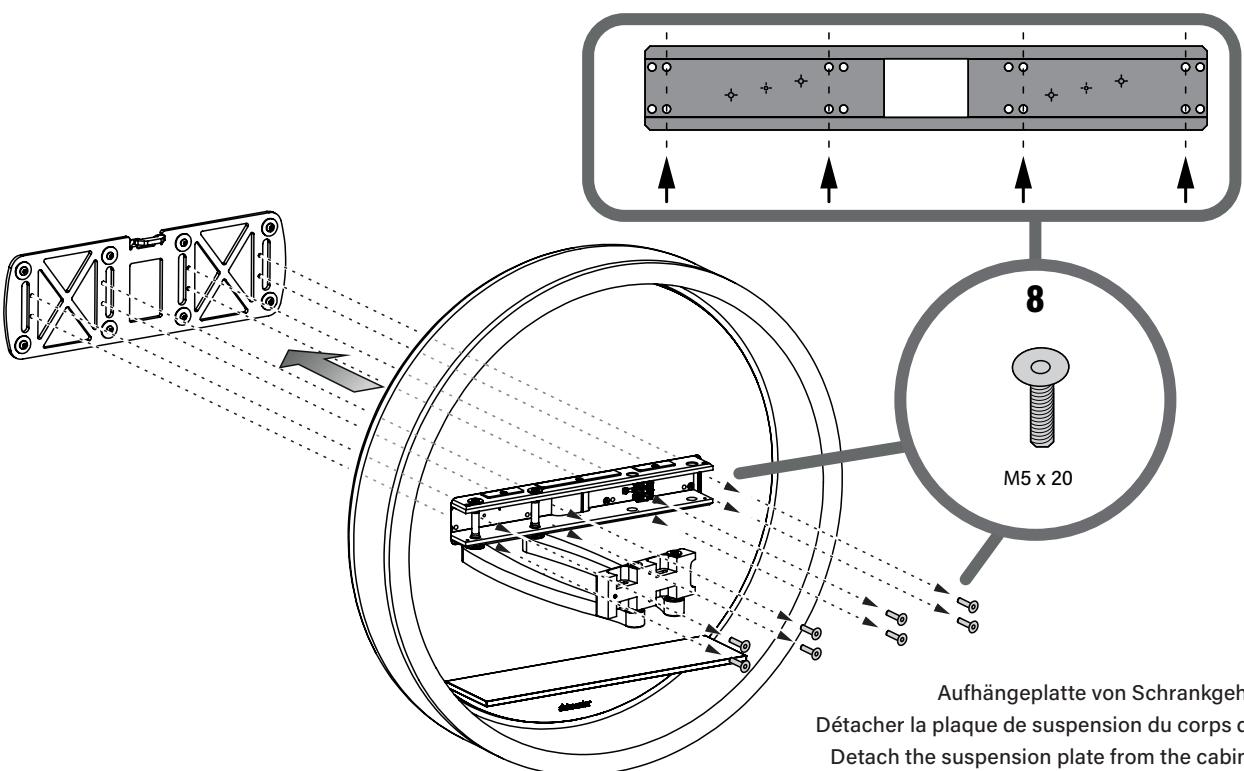
Aufhängeplatte von Schrankgehäuse lösen.
