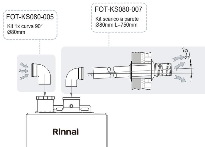
**NB:** ove l'apparecchio venga installato in ambiente esterno, esposto alla diretta azione degli elementi atmosferici, assicurarsi che l'apparato di aspirazione sia protetto da possibili infiltrazioni di acqua piovana.
