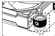
**Note!** If the radiator outlet interferes with the fan interlocking key, you can remove them/Si la sortie du radiateur interfère avec la clé d'interverrouillage du ventilateur, vous pouvez les retirer/若遇到水冷排出水位置影响风扇扣锁，可将风扇扣锁移除/ラジエーター出口がファン運動キーと干渉する場合、それらを取り外すことができます
