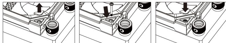
**!** Secure the fan to the radiator and cover with the rubber pads to enhance the overall aesthetics/Fixez le ventilateur au radiateur et couvrez-le avec les coussinets en caoutchouc pour améliorer l'esthétique globale/鎖上水冷排，风扇脚垫可以盖回去，讓整體更加美觀/锁上水冷排，风扇脚垫可以盖回去，让整体更加美观/ファンをラジエーターに固定し、ゴムパッドで覆って全体的な美観を向上させます
