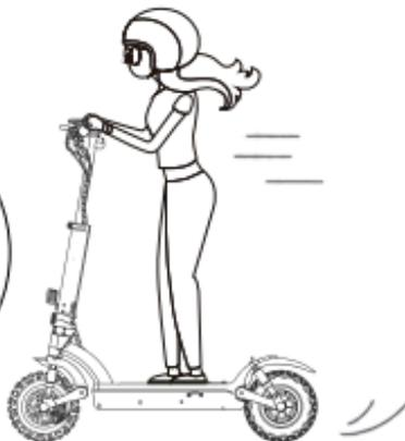
4. Relâchez l'accélérateur et le système de récupération d'énergie cinétique (KERS) s'enclenche automatiquement pour freiner lentement ; Et pressez le levier de frein pour un freinage brusque.
