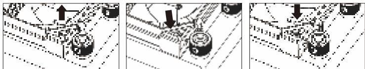
**A** Secure the fan to the radiator and cover with the rubber pads to enhance the overall aesthetics/Fiez le ventilateur au radiateur et couvrez-le avec les coussinets en caoutchouc pour améliorer l'esthétique globale/鎖上水冷排，風扇腳墊可以蓋回去，讓整體更加美觀/锁上水冷排，风扇脚垫可以盖回去，让整体更加美观/ファンをラジエーターに固定し、ゴムパッドで覆って全体的な美観を向上させます
