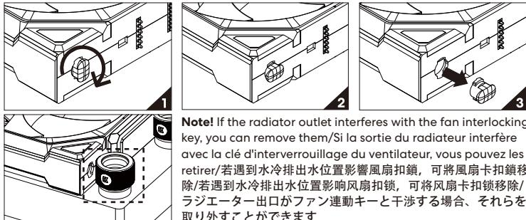
**Note!** If the radiator outlet interferes with the fan interlocking key, you can remove them/Si la sortie du radiateur interfère avec la clé d'interverrouillage du ventilateur, vous pouvez les retirer/若遇到水冷排出水位置影響風扇扣鎖，可將風扇卡扣鎖移除/ラジエーター出口がファン運動キーと干渉する場合、それらを取り外すことができます
