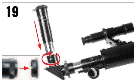
Pour obtenir un plus grand grossissement, vous pouvez utiliser la lentille de Barlow x3 incluse. Placez la lentille de Barlow dans le système de mise au point, à la place de l'oculaire. Retirez le capuchon de la lentille de Barlow.
