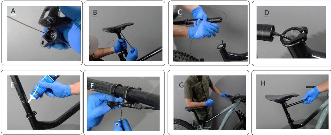
1. (새 자전거를 조립하는 경우 2 단계로 넘어갑니다) GIANT CONTACT SWITCH SL 를 설치하기 전에 자전거에서 기존 시트포스트와 안장을 제거합니다.
