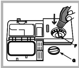
1. Aprire il serbatoio ruotando il tappo (G) in senso antiorario.
