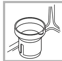
1. Estrarre il cestello inferiore e svitare il tappo del serbatoio in senso antiorario.
