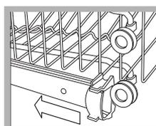
Aprire i fermi delle guide del cesto a destra e a sinistra ed estrarre il cesto; sistemarlo in alto o in basso, farlo scivolare lungo le guide fino a far entrare anche le rotelle anteriori e chiudere i fermi (vedi figura).
