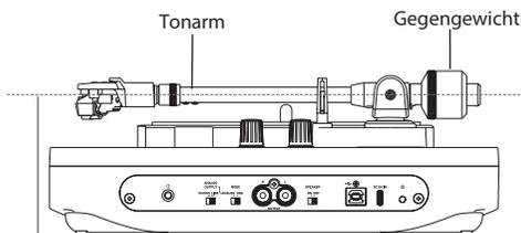
Richten Sie den Tonarm so aus, dass er horizontal ausbalanciert ist.
