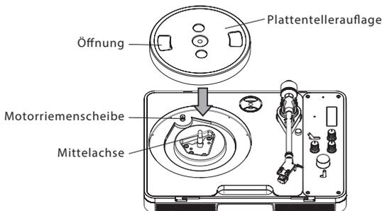
2. Befestigen Sie den Riemen an der Motorriemenscheibe.
