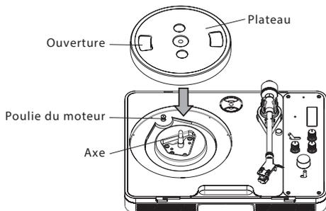
2. Fixez la courroie d'entraînement sur la poulie du moteur. Alignez l'ouverture du plateau sur la poulie du moteur et fixez la courroie d'entraînement sur la poulie du moteur en tirant la courroie vers le haut à l'aide du ruban rouge fourni (voyez l'illustration).
