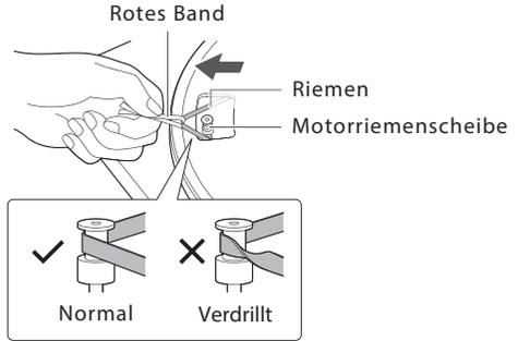
Der Riemen darf nicht verdrillt sein, wenn Sie ihn an der Motorriemenscheibe befestigen. Entfernen Sie das rote Band.
