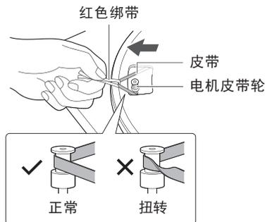
皮带连接至皮带轮时不应扭转。取下红色绑带。
