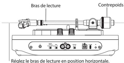
2. Tournez la bague de mesure du contrepoids et alignez-la sur 0.
