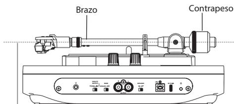
Ajuste el brazo hasta que quede en posición horizontal
