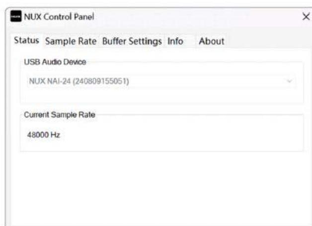
На вкладке Status (Состояние) отображается идентификационный номер аудиоустройства USB вместе с текущей частотой дискретизации.
