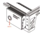
预览模式下,再次按下微动开关,机器进入雕刻模式,此时激光头会发出强光,机器开始雕刻,指示灯常亮。
