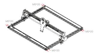
4. 安装三个脚架以及控制盒组件: 共使用 8 颗 M5\*20 内六角平圆头螺丝锁紧。
