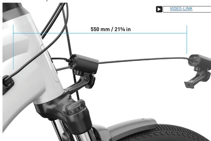
Bei einigen Turbo Vado, Turbo Como, Turbo Tero X, und Turbo Tero EQ Modellen der Baujahre 2022/2023 ist das Kabel der Frontleuchte nicht lang genug, um das Leuchte an diesem Gepäckträger zu montieren. Diese Komponente muss von einem autorisierten Specialized-Fachhändler montiert werden.
