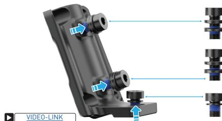
1. Die drei Befestigungsschrauben für den Frontgepäckträger werden vormontiert in der Frontplatte geliefert und müssen vor der Montage entfernt werden. Merke dir die Position jeder Schraube und deren Unterlegscheiben. Diese müssen wieder in der gleichen Position und Ausrichtung montiert werden.
