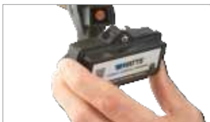
5. Enfoncez le module d'activation sur le capteur.
