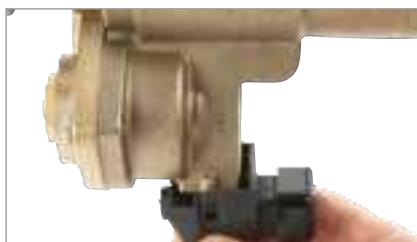
2. Empuje el sensor en la válvula de alivio.
