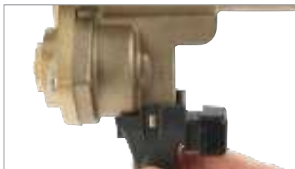
3. Compruebe que el sensor esté firmemente asentado en las lengüetas de la válvula de alivio.
