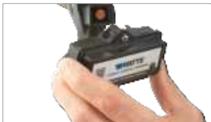
5. Presione el módulo de activación sobre el sensor.
