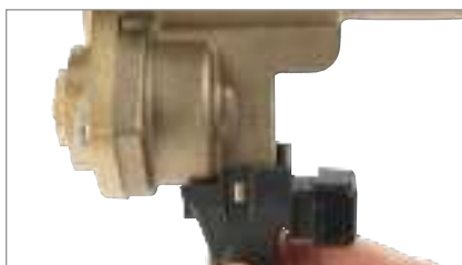
3. Vérifiez que le capteur est bien en place sur les languettes de la soupape de décharge.
