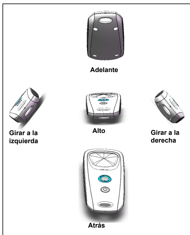
Figura 21. Comandos direccionales del control remoto
