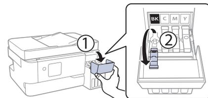
**Nota:** Consulte la etiqueta de colores en la unidad de tanques de tinta para identificar el color de cada tanque.
