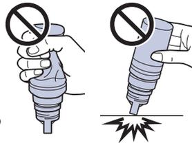
**Nota:** La tinta fluye en el tanque y se detiene automáticamente cuando llega a la línea superior del tanque de tinta. Si la tinta no fluye de la botella, levántela y vuélvala a colocar.
