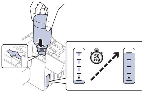
**Nota:** No inserte la botella por la fuerza; cada botella está diseñada para funcionar exclusivamente con el tanque de tinta del color correspondiente.
