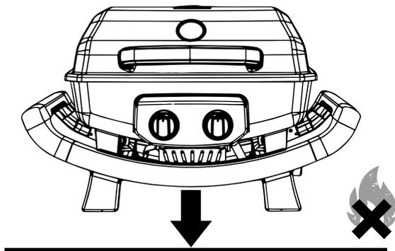
**ATTENTION :** Avant la mise en service, vérifie si les brûleurs sont correctement placés sur les buses respectives. Si ce n'est pas le cas, tourne les dispositifs de blocage des brûleurs de 90°, retire le brûleur et le repositionne sur les buses. Ensuite, bloque à nouveau les brûleurs.
